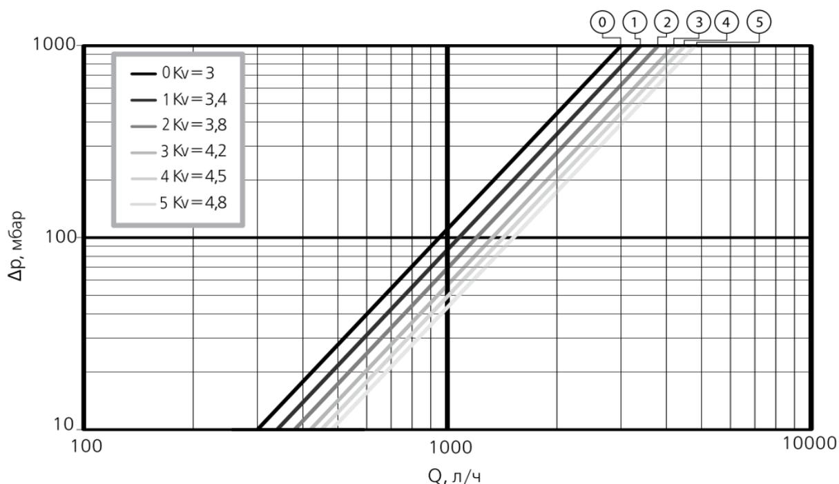
Устанавливая байпас в позицию 0 при расходе 1032 л/ч, получим потерю давления  $R_{ск}$  150 мбар (0,15 бар). Сопротивление низкотемпературного контура  $\Delta R_{нк} = 0,25$  бар.
