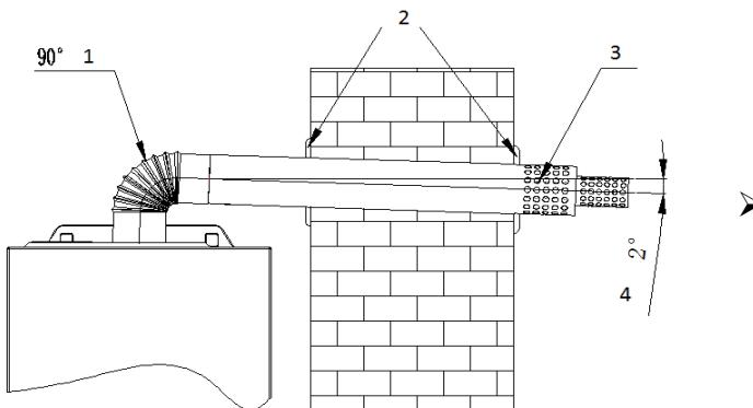
1-  $90^0$  патрубок; 2-уплотнение трубы дымоотвода; 3- труба дымоотвода; 4-уклон  $2^0$
