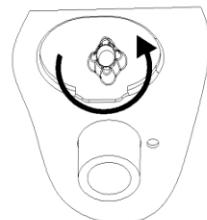
3. Обратите внимание на дисплей, когда давление достигнет 1Bar-1.5Bar, закройте кран подпитки системы отопления.
