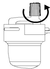
2. Вращение против часовой стрелки крана подпитки воды осуществляет поступление теплоносителя в систему отопления
