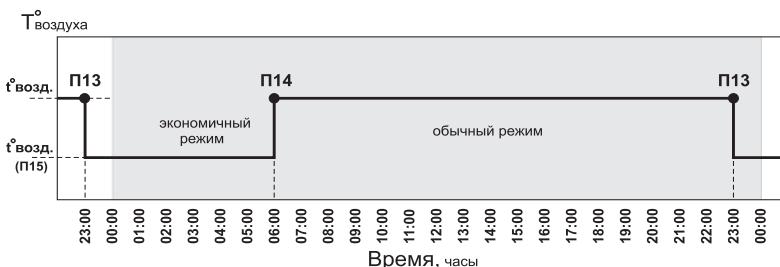
**Рис.7 График температуры воздуха в помещении для Режима 2**
