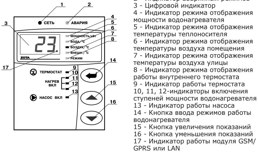
**Рис.2 Расположение органов управления на передней панели**
