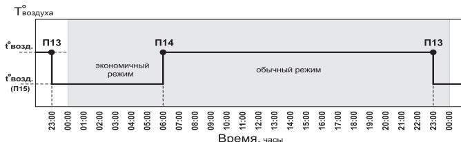
**Рис.7 График температуры воздуха в помещении для Режима 2**
