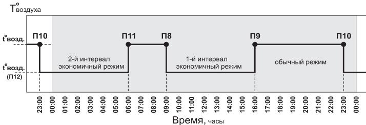
**Рис.6 График температуры воздуха в помещении для Режима 1**
