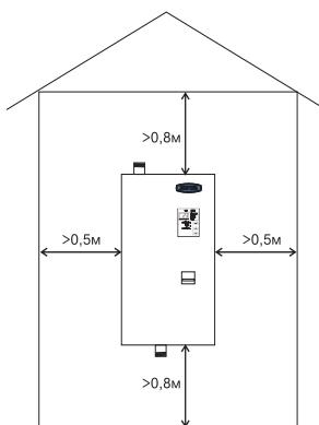
**Рис.4 Схема установки электроподогревателя**
