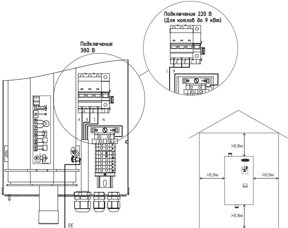
**Рис.3 Схема подключения электроводонагревателя**
