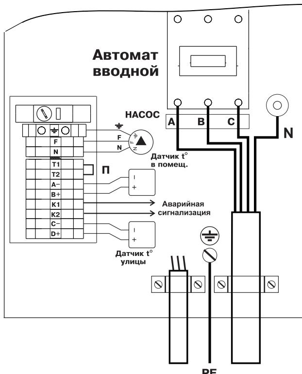
**Рис.3 Схема подключения электроподогревателя**
