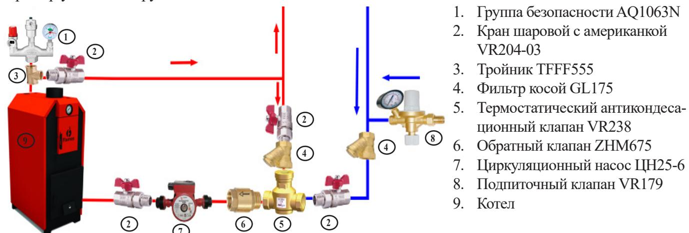
**Внимание!** Приведенная схема носит исключительно информационно-ознакомительный характер, параметры насоса расчитываются индивидуально для систем отопления с учетом гидравлического сопротивления системы.
