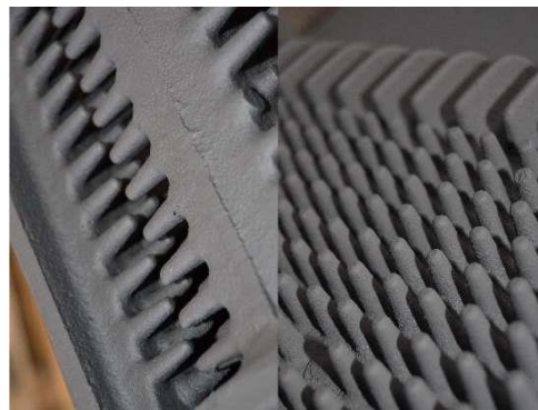
Рисунок 1. Внешний вид поверхностей теплообменника
