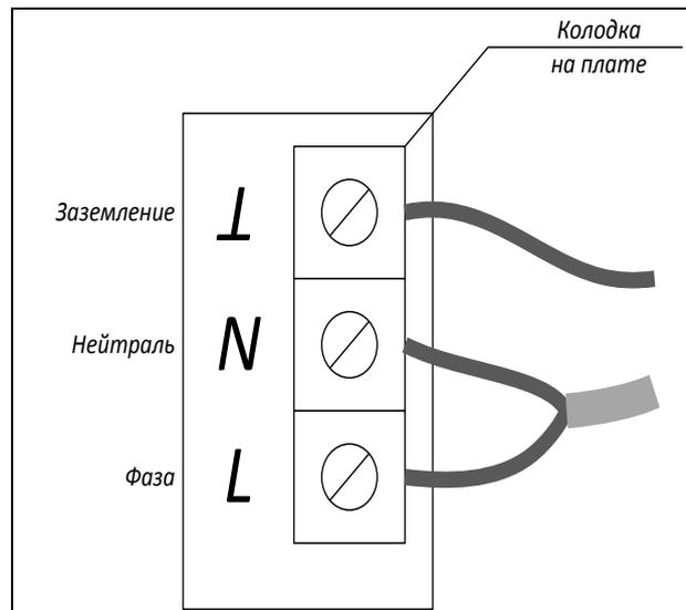
Рисунок 8. Подключение GSM или WiFi модуля к электродотлу РЭКО серии П
