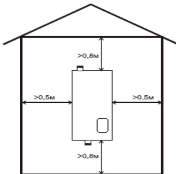
Схема установки электрического котла
