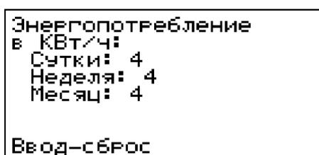
Экран «Энергопотребление» предназначен для примерной оценки потребляемой котлом электроэнергии, на основе данных о мощности ТЭНов, времени включения ТЭНов, и напряжении питания.
