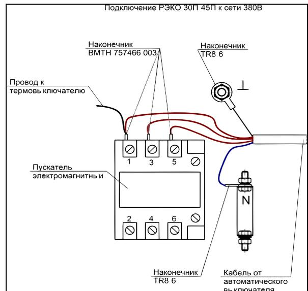
Рисунок 7. Подключение циркуляционного насоса к отопителю
