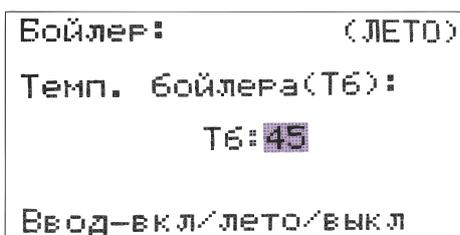
Для включения режима «Бойлер» зайдите в соответствующее подменю и установите желаемую температуру ГВС. Гистерезис настроен на температуру +3/-3С. Бойлер в режиме «вкл» – работает по заданному циклу с приоритетом на ГВС. В режиме «лето» - подогрев идет только на водоснабжение.
