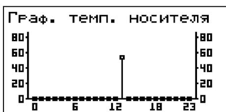
Экраны «График температуры теплоносителя» и «График температуры воздуха» предназначены для отображения информации о динамике температуры в течение суток.
