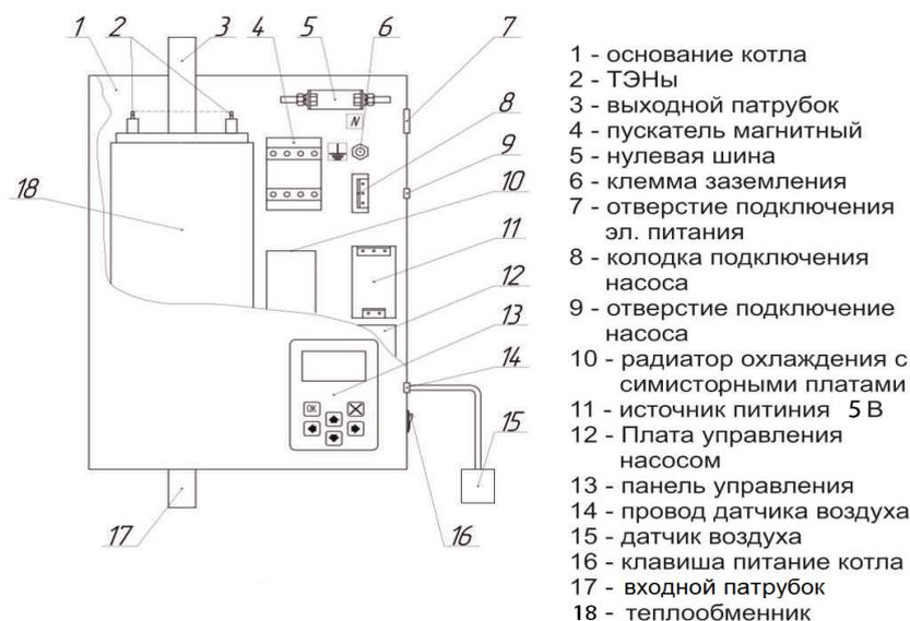
Рисунок 1. Устройство отопителя РЭКО серии П
