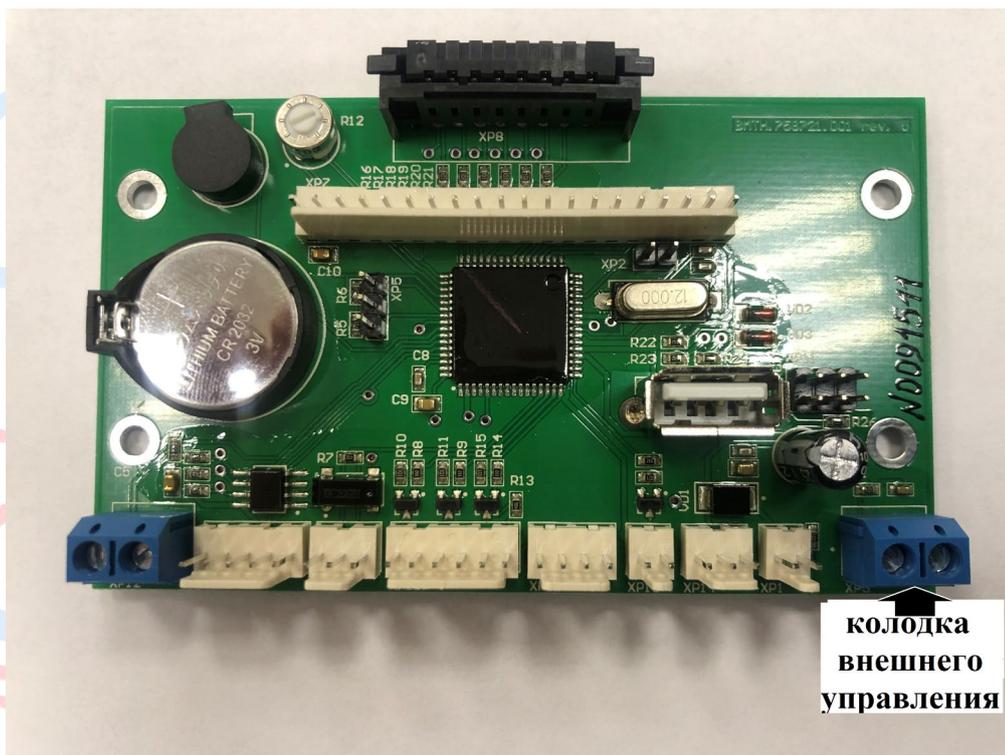
Рисунок 9. Подключение GSM или WiFi модуля к электродотлу РЭКО серии ПМ
