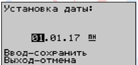
Экран «Установка даты» предназначен для ручного ввода текущей даты и дня недели. Текущая дата будет использоваться для определения выходных/будних дней, а так же при подсчете величин энергопотребления.
