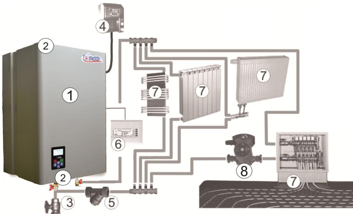
**Рисунок 4. Примерная схема построения отопительной системы на основе отопителя РЕКО серии ПМ**
