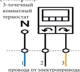
Подключите электрический сервопривод VR1137 к 3-х точечному комнатному контроллеру (термостату) согласно электрической схеме указанной производителем.
