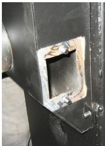
Рис. 10. Отверстие для чистки адаптера дымохода.
